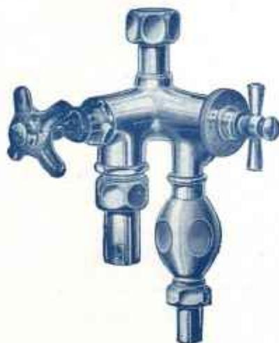
Cet appareil de circuit d'alimentation en eau froide groupe, dans un même ensemble: le robinet d'arrêt, le clapet de retour, la soupape de sûreté, le robinet de vidange et le contrôleur d'expansion et de vidange.
